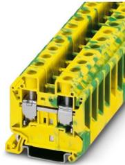
Schutzleiter-Reihenklemme, Anzahl der Anschlüsse: 2, Anschlussart: Schraubanschluss, Bemessungsquerschnitt: 16 mm<sup>2</sup>, Querschnitt: 1,5 mm<sup>2</sup> - 25 mm<sup>2</sup>, Montageart: NS 35/7,5, NS 35/15, Farbe: grün-gelb
