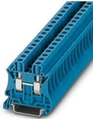
Durchgangsklemme, Nennspannung: 1000 V, Nennstrom: 41 A, Anzahl der Anschlüsse: 2, Anschlussart: Schraubanschluss, Bemessungsquerschnitt: 6 mm<sup>2</sup>, Querschnitt: 0,2 mm<sup>2</sup> - 10 mm<sup>2</sup>, Montageart: NS 35/7,5, NS 35/15, Farbe: blau
