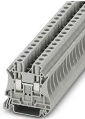
Durchgangsklemme, Nennspannung: 1000 V, Nennstrom: 41 A, Anzahl der Anschlüsse: 2, Anschlussart: Schraubanschluss, Bemessungsquerschnitt: 6 mm<sup>2</sup>, Querschnitt: 0,2 mm<sup>2</sup> - 10 mm<sup>2</sup>, Montageart: NS 35/7,5, NS 35/15, Farbe: grau
