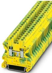
Schutzleiter-Reihenklemme, Anzahl der Anschlüsse: 2, Anschlussart: Schraubanschluss, Querschnitt: 0,14 mm<sup>2</sup> - 6 mm<sup>2</sup>, Montageart: NS 35/7,5, NS 35/15, Farbe: grün-gelb
