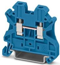
Durchgangsklemme, Nennspannung: 1000 V, Nennstrom: 32 A, Anzahl der Anschlüsse: 2, Anschlussart: Schraubanschluss, Bemessungsquerschnitt: 4 mm<sup>2</sup>, Querschnitt: 0,14 mm<sup>2</sup> - 6 mm<sup>2</sup>, Montageart: NS 35/7,5, NS 35/15, Farbe: blau
