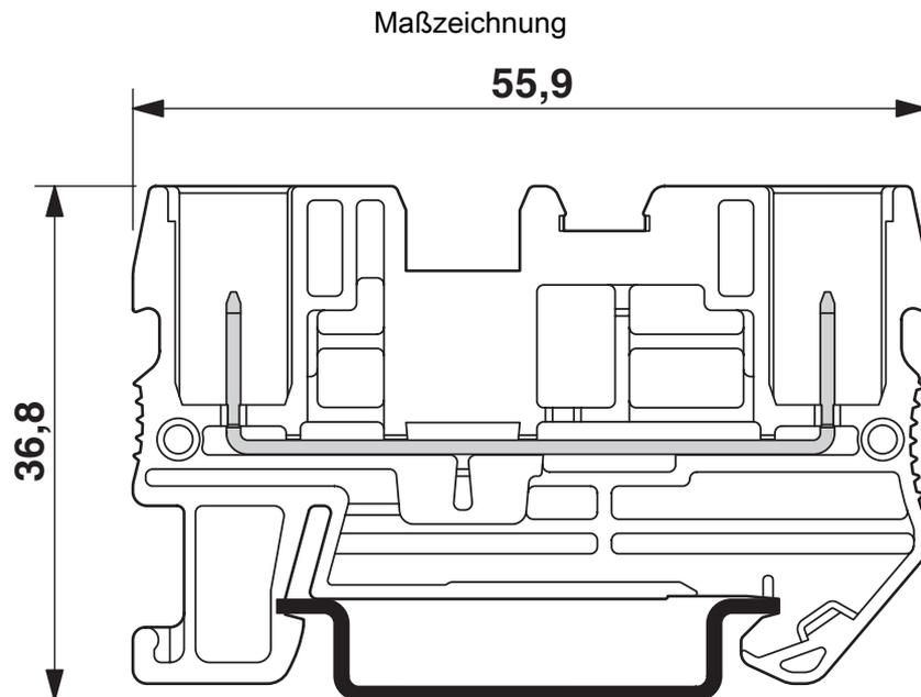
Abbildung zeigt die Klemme mit der Steckervariante SP 4/...
