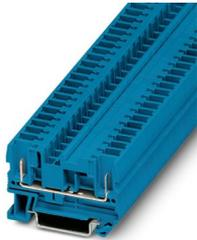
Durchgangsklemme, Nennspannung: 800 V, Nennstrom: 32 A, Anzahl der Anschlüsse: 2, Anschlussart: Steckanschluss, Bemessungsquerschnitt: 4 mm<sup>2</sup>, 1. Etage Anschluss links, Querschnitt: 0,08 mm<sup>2</sup> - 6 mm<sup>2</sup>, Montageart: NS 35/7,5, NS 35/15, Farbe: blau
