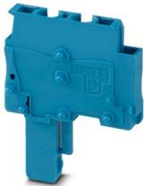
Stecker, Nennspannung: 500 V, Nennstrom: 24 A, Polzahl: 1, Anschlussart: Zugfederanschluss, Bemessungsquerschnitt: 2,5 mm<sup>2</sup>, Querschnitt: 0,08 mm<sup>2</sup>- 4 mm<sup>2</sup>, Farbe: blau
