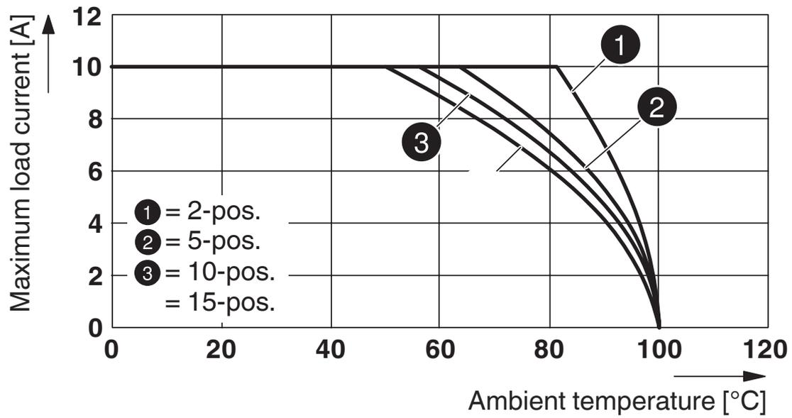
Derating-Kurve für ST 2,5-4L/1P, ST 2,5-4L/2P und für alle Steckervarianten SP...
