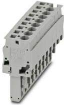
Stecker, Nennspannung: 800 V, Nennstrom: 32 A, Polzahl: 9, Anschlussart: Zugfederanschluss, Bemessungsquerschnitt: 4 mm<sup>2</sup>, Querschnitt: 0,08 mm<sup>2</sup>- 6 mm<sup>2</sup>, Farbe: grau
