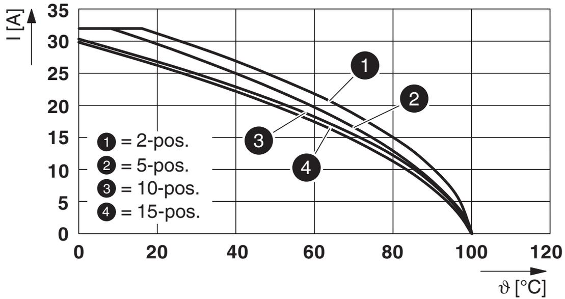
Derating-Kurve für die Zugfederklemmen ST 4/1P.. und ST 4/2P.. mit allen Steckervarianten SP 4/... . Die Derating-Kurven werden durch die Multiplikation der Werte der Basiskurven mit dem Faktor 0,8 bestimmt.
