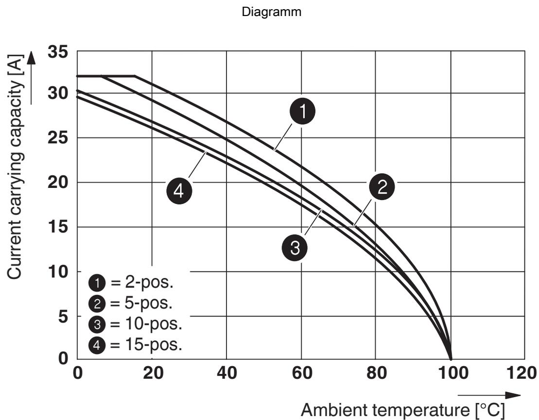
Abbildung zeigt die Derating-Kurve der Klemme ST 4... in Verbindung mit dem Stecker SP 4
