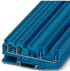
Durchgangsklemme, Nennspannung: 800 V, Nennstrom: 32 A, Anzahl der Anschlüsse: 4, Anschlussart: Zugfeder- / Steckanschluss, Bemessungsquerschnitt: 4 mm<sup>2</sup>, 1. Etage Anschluss rechts, Querschnitt: 0,08 mm<sup>2</sup> - 6 mm<sup>2</sup>, Montageart: NS 35/7,5, NS 35/15, Farbe: blau
