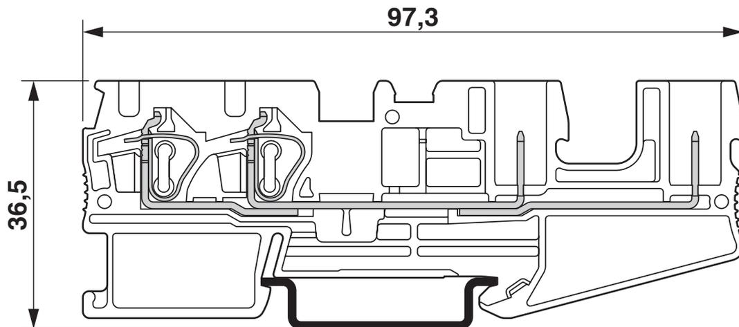
Abbildung zeigt die Klemme mit der Steckervariante SP 4/...
