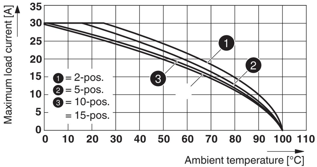
Derating-Kurve für ST 4/ 1P und für alle Steckervarianten SP...
