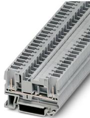
Durchgangsklemme, Nennspannung: 800 V, Nennstrom: 32 A, Anzahl der Anschlüsse: 2, Anschlussart: Steckanschluss, Bemessungsquerschnitt: 4 mm<sup>2</sup>, 1. Etage Anschluss links, Querschnitt: 0,08 mm<sup>2</sup> - 6 mm<sup>2</sup>, Montageart: NS 35/7,5, NS 35/15, Farbe: grau
