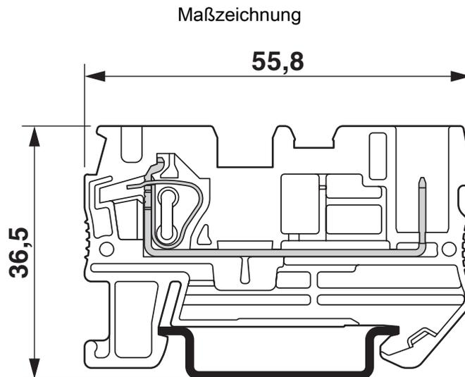
Abbildung zeigt die Klemme mit der Steckervariante SP 4/...
