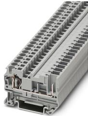
Durchgangsklemme, Nennspannung: 800 V, Nennstrom: 32 A, Anzahl der Anschlüsse: 2, Anschlussart: Zugfeder- / Steckanschluss, Bemessungsquerschnitt: 4 mm<sup>2</sup>, 1. Etage Anschluss links, Querschnitt: 0,08 mm<sup>2</sup> - 6 mm<sup>2</sup>, 1. Etage Anschluss rechts, Montageart: NS 35/7,5, NS 35/15, Farbe: grau
