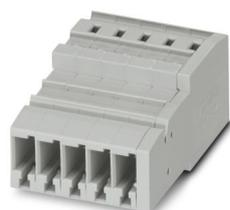
COMBI-Kupplung, Nennspannung: 800 V, Nennstrom: 32 A, Anzahl der Anschlüsse: 2, Polzahl: 5, Anschlussart: Zugfederanschluss, Bemessungsquerschnitt: 4 mm<sup>2</sup>, Querschnitt: 0,08 mm<sup>2</sup> - 6 mm<sup>2</sup>, Farbe: grau
