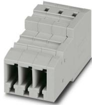
COMBI-Kupplung, Nennspannung: 800 V, Nennstrom: 32 A, Anzahl der Anschlüsse: 2, Polzahl: 3, Anschlussart: Zugfederanschluss, Bemessungsquerschnitt: 4 mm<sup>2</sup>, Querschnitt: 0,08 mm<sup>2</sup> - 6 mm<sup>2</sup>, Farbe: grau
