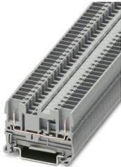
Durchgangsklemme, Nennspannung: 500 V, Nennstrom: 24 A, Anzahl der Anschlüsse: 2, Anschlussart: Steckanschluss, Bemessungsquerschnitt: 2,5 mm<sup>2</sup>, 1. Etage, Querschnitt: 0,08 mm<sup>2</sup> - 4 mm<sup>2</sup>, Montageart: NS 35/7,5, NS 35/15, Farbe: grau
