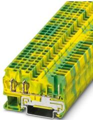
Zugfeder-Schutzleiterklemme, Anzahl der Anschlüsse: 3, Anschlussart: Zugfeder- / Steckanschluss, 1. Etage Anschluss links, Querschnitt: 0,08 mm<sup>2</sup> - 4 mm<sup>2</sup>, 1. Etage Anschluss rechts, Montageart: NS 35/7,5, NS 35/15, Farbe: grün-gelb
