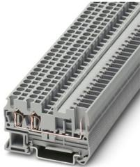
Durchgangsklemme, Nennspannung: 500 V, Nennstrom: 24 A, Anzahl der Anschlüsse: 3, Polzahl: 1, Anschlussart: Zugfeder- / Steckanschluss, Bemessungsquerschnitt: 2,5 mm<sup>2</sup>, 1. Etage Anschluss links, Querschnitt: 0,08 mm<sup>2</sup> - 4 mm<sup>2</sup>, 1. Etage Anschluss rechts, Montageart: NS 35/7,5, NS 35/15, Farbe: grau
