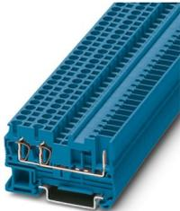
Durchgangsklemme, Nennspannung: 500 V, Nennstrom: 24 A, Anzahl der Anschlüsse: 3, Polzahl: 1, Anschlussart: Zugfeder- / Steckanschluss, Bemessungsquerschnitt: 2,5 mm<sup>2</sup>, 1. Etage Anschluss links, Querschnitt: 0,08 mm<sup>2</sup> - 4 mm<sup>2</sup>, 1. Etage Anschluss rechts, Montageart: NS 35/7,5, NS 35/15, Farbe: blau
