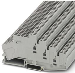
Mehrstockklemme, Nennspannung: 500 V, Nennstrom: 24 A, Anzahl der Anschlüsse: 6, Anschlussart: Zugfeder- / Steckanschluss, Querschnitt: 0,08 mm<sup>2</sup> - 4 mm<sup>2</sup>, Montageart: NS 35/7,5, NS 35/15, Farbe: grau
