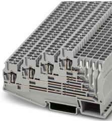
Mehrstockklemme, Nennspannung: 250 V, Nennstrom: 10 A, Anzahl der Anschlüsse: 5, Anschlussart: Zugfeder- / Steckanschluss, Bemessungsquerschnitt: 1,5 mm<sup>2</sup>, Querschnitt: 0,08 mm<sup>2</sup> - 4 mm<sup>2</sup>, Montageart: NS 35/7,5, NS 35/15, Farbe: grau
