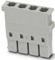
Steckergehäuse, Nennspannung: 250 V, Nennstrom: 10 A, Anzahl der Anschlüsse: 4, Polzahl: 4, Anschlussart: Crimpanschluss, Bemessungsquerschnitt: 1,5 mm<sup>2</sup>, Querschnitt: 0,5 mm<sup>2</sup> - 2,5 mm<sup>2</sup>, Montageart: Steckmontage, Farbe: grau
