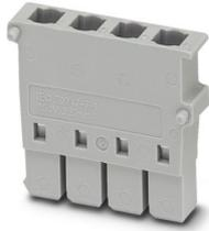
Steckergehäuse, Nennspannung: 250 V, Nennstrom: 10 A, Anzahl der Anschlüsse: 4, Polzahl: 4, Anschlussart: Crimpanschluss, Bemessungsquerschnitt: 2,5 mm<sup>2</sup>, Querschnitt: 0,5 mm<sup>2</sup> - 2,5 mm<sup>2</sup>, Montageart: Steckmontage, Farbe: grau
