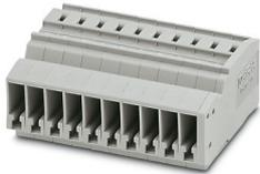
COMBI-Kupplung, Nennspannung: 500 V, Nennstrom: 24 A, Anzahl der Anschlüsse: 1, Polzahl: 10, Anschlussart: Zugfederanschluss, Bemessungsquerschnitt: 2,5 mm<sup>2</sup>, Querschnitt: 0,08 mm<sup>2</sup> - 4 mm<sup>2</sup>, Montageart: auf Montageplatte, Farbe: grau
