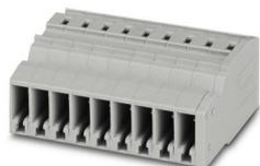
COMBI-Kupplung, Nennspannung: 500 V, Nennstrom: 24 A, Anzahl der Anschlüsse: 1, Polzahl: 9, Anschlussart: Zugfederanschluss, Bemessungsquerschnitt: 2,5 mm<sup>2</sup>, Querschnitt: 0,08 mm<sup>2</sup> - 4 mm<sup>2</sup>, Farbe: grau
