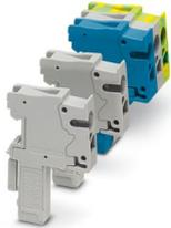
Stecker, Nennspannung: 500 V, Nennstrom: 24 A, Polzahl: 1, Anschlussart: Zugfederanschluss, Bemessungsquerschnitt: 2,5 mm<sup>2</sup>, Querschnitt: 0,08 mm<sup>2</sup>- 4 mm<sup>2</sup>, Farbe: grün-gelb
