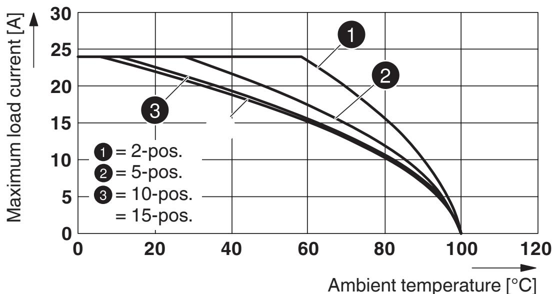
Derating-Kurve für ST 2,5-QUATTRO/2P, ST 2,5-QUATTRO/4P und für alle Steckervarianten SP ... .
