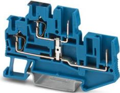
Doppelstockklemme, Strom und Spannung werden durch den eingesetzten Stecker bestimmt., mit Potenzialverbinder, Nennspannung: 500 V, Nennstrom: 22 A, Anschlussart: Zugfeder- / Steckanschluss, 1. und 2. Etage Anschluss links, Bemessungsquerschnitt: 2,5 mm<sup>2</sup>, Querschnitt: 0,08 mm<sup>2</sup> - 4 mm<sup>2</sup>, 1. und 2. Etage Anschluss rechts, Montageart: NS 35/15, NS 35/7,5, Farbe: blau
