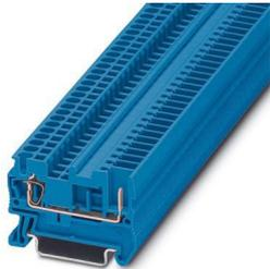
Durchgangsklemme, Nennspannung: 500 V, Nennstrom: 24 A, Anzahl der Anschlüsse: 2, Anschlussart: Zugfeder- / Steckanschluss, Bemessungsquerschnitt: 2,5 mm<sup>2</sup>, 1. Etage Anschluss links, Querschnitt: 0,08 mm<sup>2</sup> - 4 mm<sup>2</sup>, 1. Etage Anschluss rechts, Montageart: NS 35/7,5, NS 35/15, Farbe: blau
