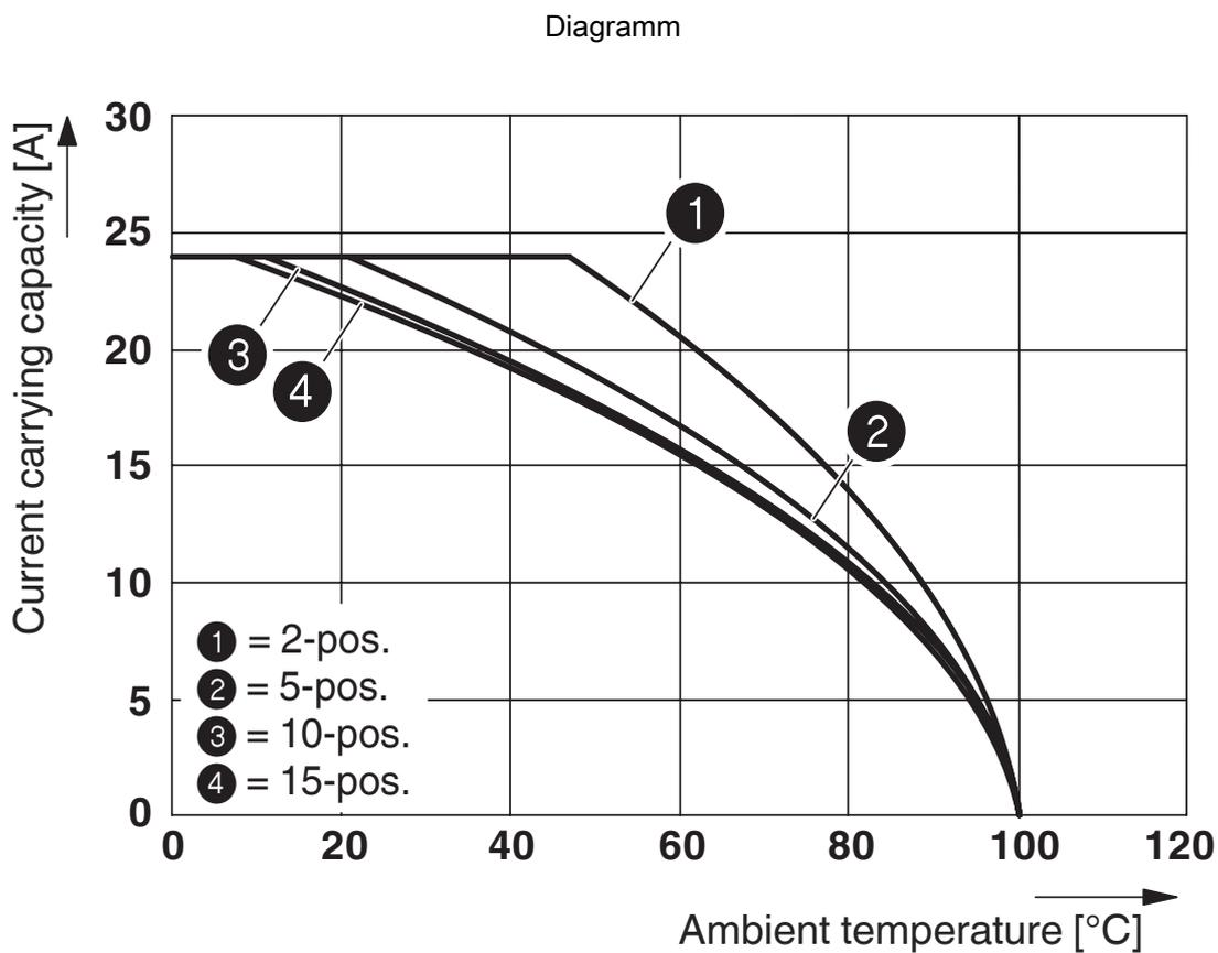
Abbildung zeigt die Derating-Kurve der Klemme ST 2,5... in Verbindung mit dem Stecker SP 2,5
