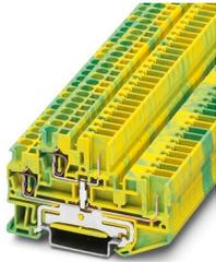
Schutzleiter-Doppelstockklemme, Nennspannung: 500 V, Nennstrom: 22 A, Anschlussart: Zugfeder- / Steckanschluss, 1. und 2. Etage Anschluss links, Bemessungsquerschnitt: 2,5 mm<sup>2</sup>, Querschnitt: 0,08 mm<sup>2</sup> - 4 mm<sup>2</sup>, Montageart: NS 35/15, NS 35/7,5, Farbe: grün-gelb
