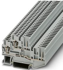
Doppelstockklemme, Strom und Spannung werden durch den eingesetzten Stecker bestimmt., Nennspannung: 500 V, Nennstrom: 22 A, Anschlussart: Zugfeder- / Steckanschluss, 1. und 2. Etage Anschluss links, Bemessungsquerschnitt: 2,5 mm<sup>2</sup>, Querschnitt: 0,08 mm<sup>2</sup> - 4 mm<sup>2</sup>, 1. und 2. Etage Anschluss rechts, Montageart: NS 35/15, NS 35/7,5, Farbe: grau
