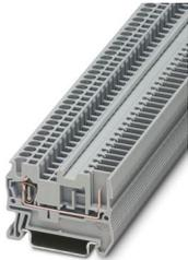
Durchgangsklemme, Nennspannung: 500 V, Nennstrom: 24 A, Anzahl der Anschlüsse: 2, Anschlussart: Zugfeder- / Steckanschluss, Bemessungsquerschnitt: 2,5 mm<sup>2</sup>, 1. Etage Anschluss links, Querschnitt: 0,08 mm<sup>2</sup> - 4 mm<sup>2</sup>, 1. Etage Anschluss rechts, Montageart: NS 35/7,5, NS 35/15, Farbe: grau
