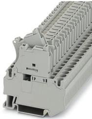
Sicherungsreihenklemme, Art der Sicherung: Glas / Keramik / ..., Sicherungstyp: G / 5 x 20, Nennspannung: 500 V, Nennstrom: 6,3 A, Anschlussart: Zugfederanschluss, 1. Etage, Bemessungsquerschnitt: 1 mm<sup>2</sup>, Querschnitt: 0,08 mm<sup>2</sup>- 6 mm<sup>2</sup>, Montageart: NS 35/7,5, NS 35/15, Farbe: grau
