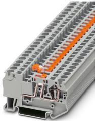
Messertrennklemme, Nennspannung: 400 V, Nennstrom: 20 A, 1. Etage, Anschlussart: Zugfederanschluss, Bemessungsquerschnitt: 4 mm<sup>2</sup>, Querschnitt: 0,08 mm<sup>2</sup> - 6 mm<sup>2</sup>, Montage: NS 35/7,5, NS 35/15, Farbe: grau
