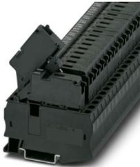
Sicherungsreihenklemme, Art der Sicherung: Glas / Keramik / ..., Sicherungstyp: G / 6,3 x 32, Nennspannung: 250 V, Nennstrom: 10 A, Anschlussart: Zugfederanschluss, 1. Etage, Bemessungsquerschnitt: 1,5 mm<sup>2</sup>, Querschnitt: 0,08 mm<sup>2</sup>- 6 mm<sup>2</sup>, Montageart: NS 35/7,5, NS 35/15, Farbe: schwarz
