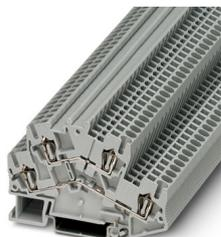
Doppelstock-Zugfederklemme, Nennspannung: 500 V, Nennstrom: 22 A, Anschlussart: Zugfederanschluss, 1. und 2. Etage, Bemessungsquerschnitt: 2,5 mm<sup>2</sup>, Querschnitt: 0,08 mm<sup>2</sup> - 4 mm<sup>2</sup>, Montageart: NS 35/7,5, NS 35/15, Farbe: grau
