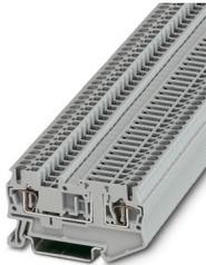
Trennklemme, Strom und Spannung werden durch den eingesetzten Stecker bestimmt., Nennspannung: 400 V, Nennstrom: 20 A, Anschlussart: Zugfederanschluss, Bemessungsquerschnitt: 2,5 mm<sup>2</sup>, Querschnitt: 0,08 mm<sup>2</sup> - 4 mm<sup>2</sup>, Montage: NS 35/7,5, NS 35/15, Farbe: grau
