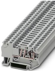
Trennklemme, Strom und Spannung werden durch den eingesetzten Stecker bestimmt., Nennspannung: 500 V, Nennstrom: 20 A, Anschlussart: Zugfederanschluss, Bemessungsquerschnitt: 4 mm<sup>2</sup>, Querschnitt: 0,08 mm<sup>2</sup> - 6 mm<sup>2</sup>, Montage: NS 35/7,5, NS 35/15, Farbe: grau
