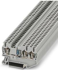
Bauelementreihenklemme, Nennspannung: 800 V, Nennstrom: 0,5 A, Anzahl der Anschlüsse: 3, Anschlussart: Zugfederanschluss, Bemessungsquerschnitt: 1 mm<sup>2</sup>, 1. Etage, Querschnitt: 0,08 mm<sup>2</sup> - 4 mm<sup>2</sup>, Montageart: NS 35/7,5, NS 35/15, Farbe: grau
