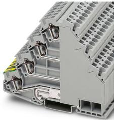
Motorenklemme, Vierstock, Anschlussart: Zugfederanschluss, Querschnitt: 0,08 mm<sup>2</sup> - 6 mm<sup>2</sup>, AWG: 28 - 10, Breite: 6,2 mm, Farbe: grau, Montageart: NS 35/7,5, NS 35/15
