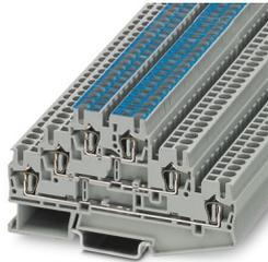
Durchgangsklemme, Nennspannung: 500 V, Nennstrom: 24 A, Anschlussart: Zugfederanschluss, 1., 2. und 3. Etage, Bemessungsquerschnitt: 2,5 mm<sup>2</sup>, Querschnitt: 0,08 mm<sup>2</sup> - 4 mm<sup>2</sup>, Montageart: NS 35/7,5, NS 35/15, Farbe: grau
