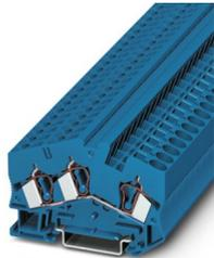
Durchgangsklemme, Nennspannung: 800 V, Nennstrom: 41 A, Anzahl der Anschlüsse: 3, Anschlussart: Zugfederanschluss, Bemessungsquerschnitt: 6 mm<sup>2</sup>, 1. Etage, Querschnitt: 0,2 mm<sup>2</sup> - 10 mm<sup>2</sup>, Montageart: NS 35/7,5, NS 35/15, Farbe: blau
