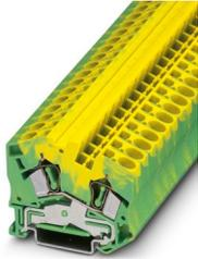
Zugfeder-Schutzleiterklemme, Anzahl der Anschlüsse: 2, Anschlussart: Zugfederanschluss, 1. Etage, Querschnitt: 0,2 mm<sup>2</sup> - 10 mm<sup>2</sup>, Montageart: NS 35/7,5, NS 35/15, Farbe: grün-gelb
