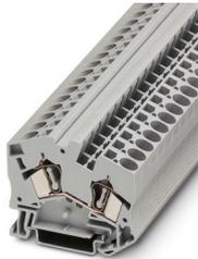
Durchgangsklemme, Nennspannung: 800 V, Nennstrom: 41 A, Anzahl der Anschlüsse: 2, Anschlussart: Zugfederanschluss, Bemessungsquerschnitt: 6 mm<sup>2</sup>, 1. Etage, Querschnitt: 0,2 mm<sup>2</sup> - 10 mm<sup>2</sup>, Montageart: NS 35/7,5, NS 35/15, Farbe: grau
