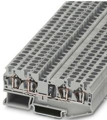
Bauelementreihenklemme, mit eingebauter Diode 1N 5408, Nennspannung: 800 V, Nennstrom: 1,5 A, Anzahl der Anschlüsse: 4, Anschlussart: Zugfederanschluss, Bemessungsquerschnitt: 1 mm<sup>2</sup>, Querschnitt: 0,08 mm<sup>2</sup> - 6 mm<sup>2</sup>, Montageart: NS 35/7,5, NS 35/15, Farbe: grau
