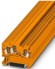
Durchgangsklemme, Nennspannung: 800 V, Nennstrom: 24 A, Anzahl der Anschlüsse: 3, Anschlussart: Zugfederanschluss, Bemessungsquerschnitt: 2,5 mm<sup>2</sup>, 1. Etage, Querschnitt: 0,08 mm<sup>2</sup> - 4 mm<sup>2</sup>, Montageart: NS 35/7,5, NS 35/15, Farbe: orange
