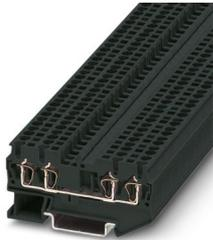
Durchgangsklemme, Nennspannung: 800 V, Nennstrom: 24 A, Anzahl der Anschlüsse: 4, Anschlussart: Zugfederanschluss, Bemessungsquerschnitt: 2,5 mm<sup>2</sup>, Querschnitt: 0,08 mm<sup>2</sup> - 4 mm<sup>2</sup>, Montageart: NS 35/7,5, NS 35/15, Farbe: schwarz
